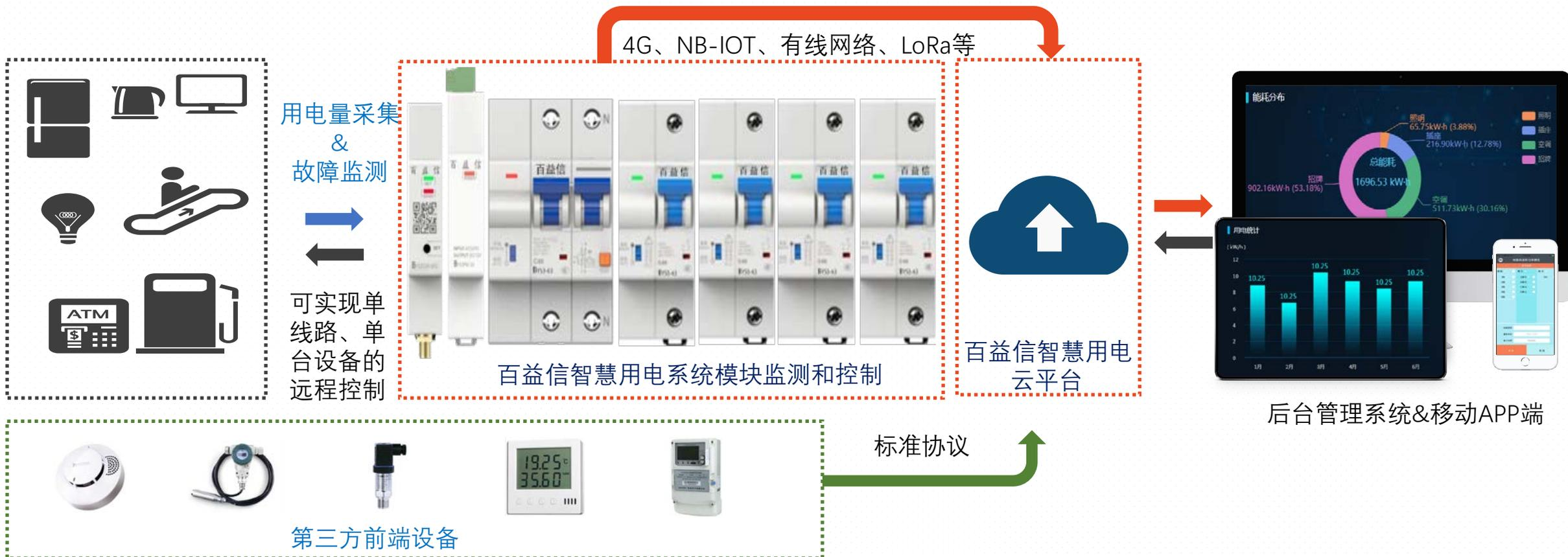
百益信智慧用电系统模块内置芯片和传感器，自行判断负载和故障，智能检测设备增减，实时、有效
